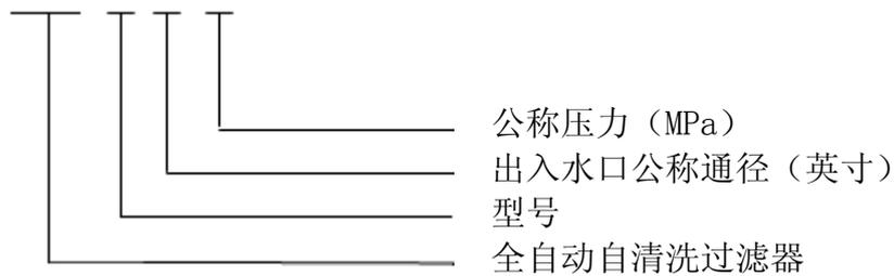
型号示例：4 英寸 ST 型全自动自清洗过滤器，公称压力为 1.6MPa，表示为 CNAF-ST04-1.6
