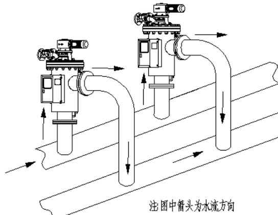
6)过滤器应安装在系统需保护的用水设备之前,其安装位置应尽量靠近被保护设备。
